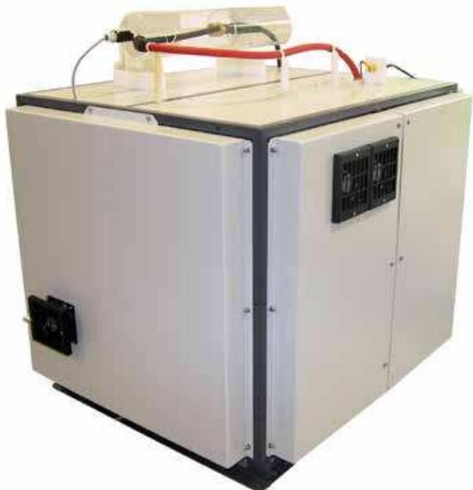
▲ Testoppsettet for VLF testing er enkelt og 3 faser i parallelle kan testes samtidig om utstyret er kraftig nok for dette, dvs. om det kan teste høy nok  $\mu\text{F}$ .
